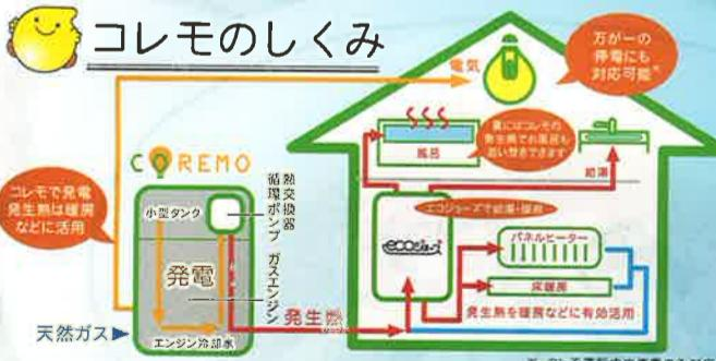
ガスで作った電気はおうちで使用した電力量に合わせて最大1.5kWまで発電する負荷追従型。同時に発生した熱はパネルヒーターなどの暖房やお風呂の追い焚きを利用することができます。
