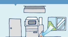
給気口が荷物などで塞がっていないか、確認してください。給気不足だと不完全燃焼を起こし、CO中毒の原因となります。
