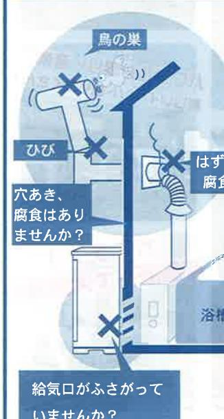
ガス機器の給排気口や換気設備の吸い込み口は、油やほこり等がたまりやすくなります。給気不足になると不完全燃焼を起し一酸化炭素(CO)中毒の原因となります。日頃から換気を効果的に行えるような点検・清掃が必要です。また煙突のある風呂がま、給湯器を使用している場合は、外れたり穴あきがないか時々チェックしてください。煙突に鳥の巣を作ったり異物が詰まることがあります。異常がある場合、また設備の経年劣化等は事故の原因になることもありますため、ガス機器メーカー等へ定期的な点検・メンテナンスの依頼を。
