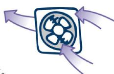
ガスが燃えるには新鮮な空気が必要です。ガス機器を使うときは、換気扇を回す、窓を開けるなど必ず換気をしましょう。燃焼するための空気(酸素)が不足するとガス機器が不完全燃焼を起こし、一酸化炭素(CO)中毒の原因になる恐れがあります。
